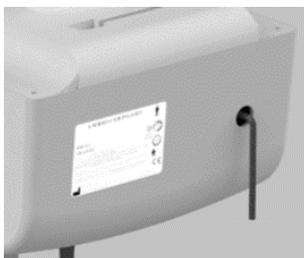
Figure 7 : Logement de la clé Allen
