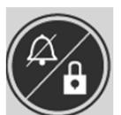
**Fonction verrouillage** : La pompe est aussi équipée d'une fonction de verrouillage au cas où quelqu'un ait changé le réglage involontairement. L'aidant peut manuellement activer la fonction de verrouillage en appuyant et en tenant le bouton LOCK pendant 3 secondes. Pour déverrouiller, appuyer et tenir le bouton LOCK sur le panneau avant pendant 3 secondes.
