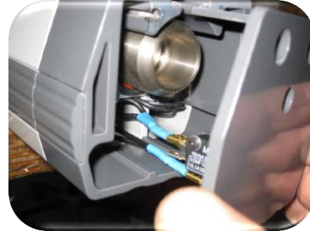
Bild 4: Entfernen Sie den Deckel vorsichtig. Achten Sie darauf, dass Sie die Steckverbindungen nicht abreißen.
