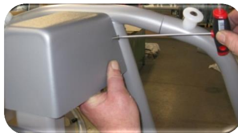
Bild 10: Jetzt können Sie die Sitzhaube mit allen 4 Schrauben montieren.
