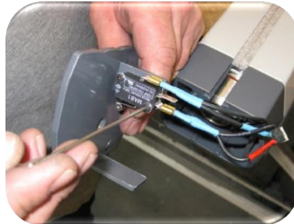
Bild 5: Entfernen Sie die 2 Schrauben von dem Mikroschalter.
