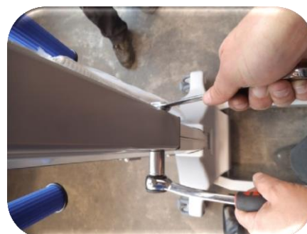
Bild 6: Ziehen Sie jetzt mit der Ratsche und dem Ringschlüssel die Schrauben unten fest an.
