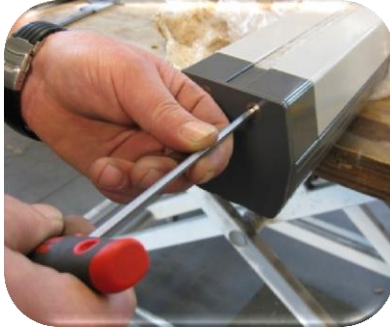
Bild 2.1: Entfernen Sie die 2 Schrauben aus der Abdeckung.
