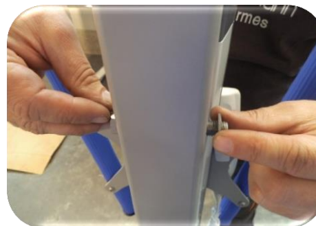
Bild 4: Bringen Sie nun von der anderen Seite aus die Unterlegscheibe an.
