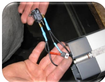
Bild 7: Nehmen Sie den neuen Mikroschalter und klemmen Sie die zwei Steck- verbindungen an.
