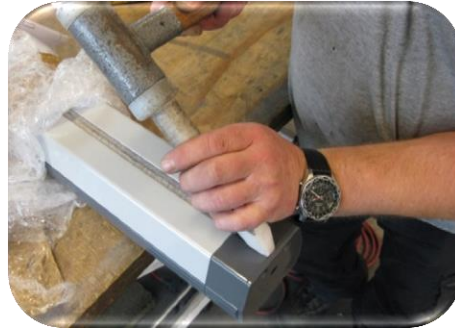
Bild 3: Entfernen Sie den Deckel vorsichtig durch leichte Schläge mit einem Kunststoffkeil und Hammer.
