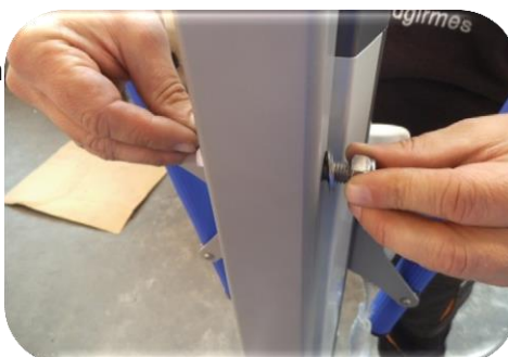
Bild 5: Bringen Sie nun die Sicherungs- mutter an.
