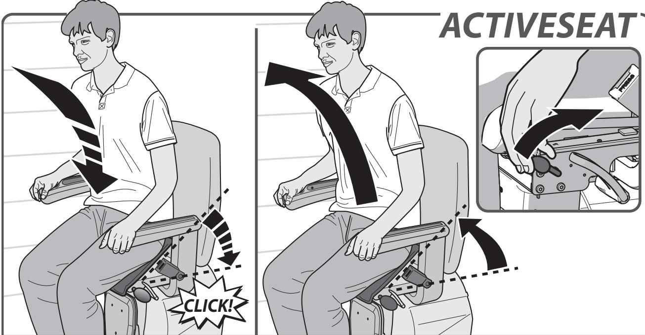
Mit der Option ACTIVESEAT unterstützt Sie der Sitz beim Aufstehen und Platz nehmen. Ziehen Sie vor dem Aufstehen den Hebel links oder rechts unter dem Sitz nach oben. Der Sitz drückt Sie nun nach oben. Wenn Sie wieder Platz nehmen möchten, gleitet der Sitz langsam nach unten und rastet ein. Solange der Sitz nicht eingerastet ist, wird sich der Lift nicht in Bewegung setzen.
