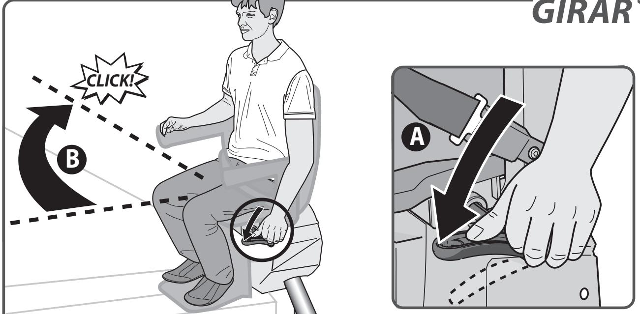
El salvaescaleras se parará automáticamente al final del riel. Ahora puede girar la silla manualmente para levantarse y bajar del salvaescaleras con mayor facilidad. Para ello, empuje la palanca hacia abajo {A}. Gire la silla hasta que oiga un clic. La silla está ahora en la posición correcta {B}.
