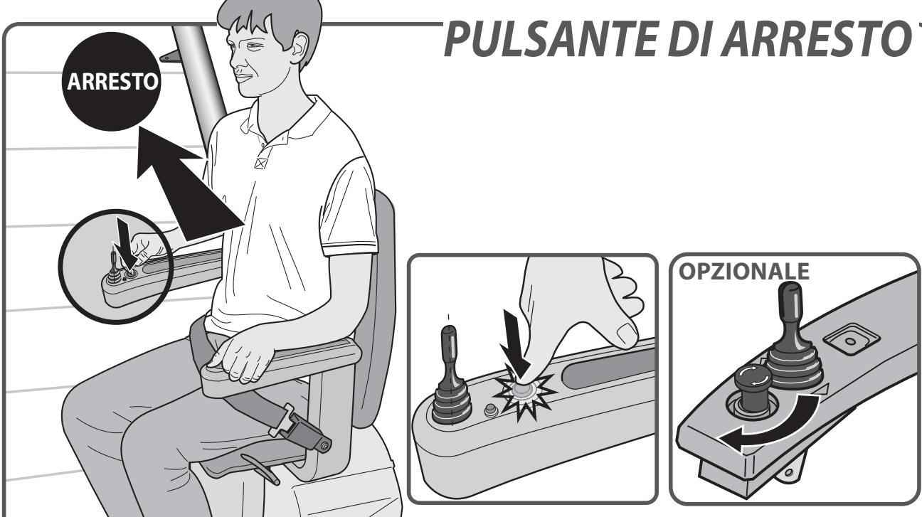
In caso di emergenza, premere il pulsante di Stop una volta. Il montascale si ferma immediatamente. Per sbloccare il montascale, premere di nuovo il pulsante di Stop.
