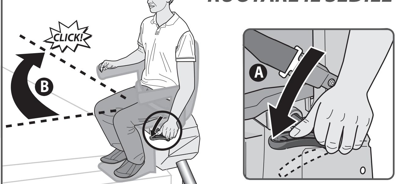
Il montascale si ferma automaticamente alla fine della guida. Ora è possibile girare manualmente il sedile per salire e scendere più facilmente. Tirare all'indietro la maniglia {A}. Ruotare il sedile fino a quando non si sente uno scatto indicante che il sedile si trova nella posizione giusta {B}.
