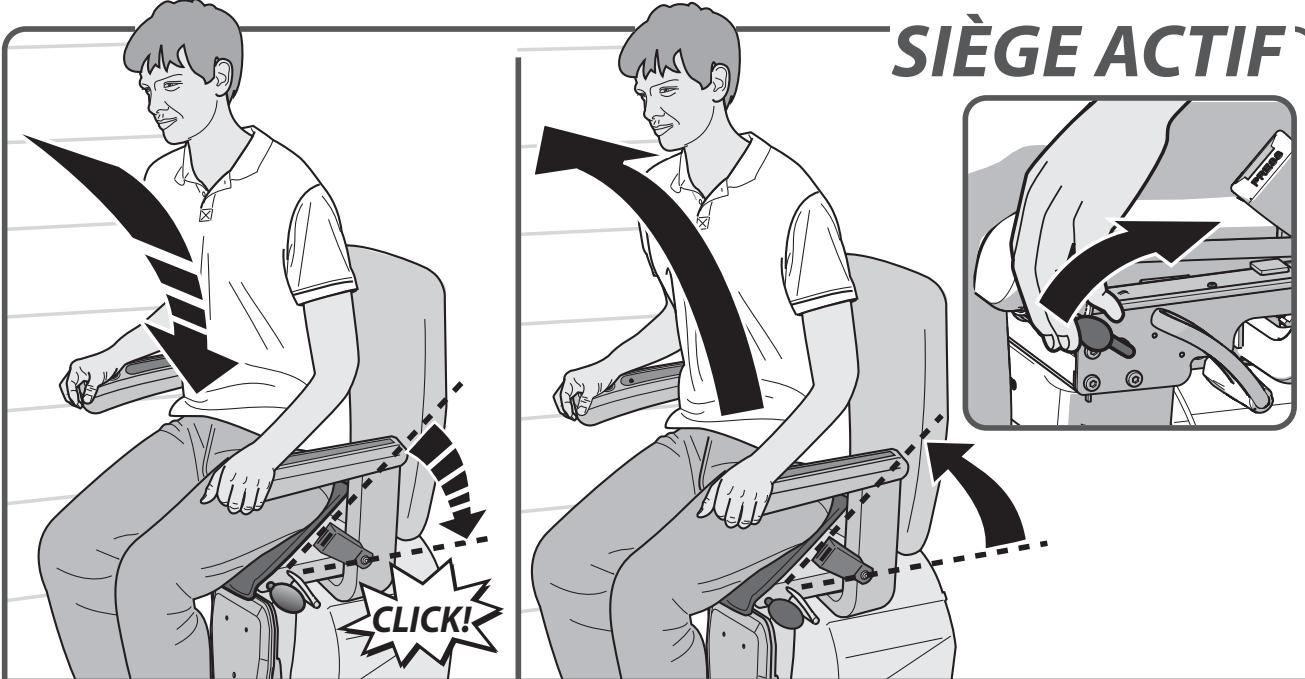
Grâce à l'option SIÈGE ACTIF, le siège vous aide à vous asseoir et à vous lever. Avant de vous lever, tirez vers le haut la poignée se trouvant à gauche ou à droite sous l'assise. Le siège vous pousse à présent vers le haut. Lorsque vous prenez de nouveau place sur le siège, l'assise s'abaisse lentement et se fixe. Tant que l'assise n'est pas fixée, le monte-escalier ne peut se mettre en mouvement.
