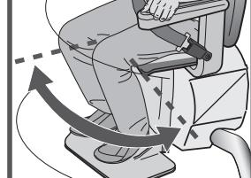
En el dibujo al lado se muestran los componentes de control de la silla Classic. Para aumentar el confort y la facilidad de uso, puede ampliar la Classic con las siguientes opciones: rotación automática 1-caminos, reposapiés automático, riel plegable y rotación automática 2-caminos.
