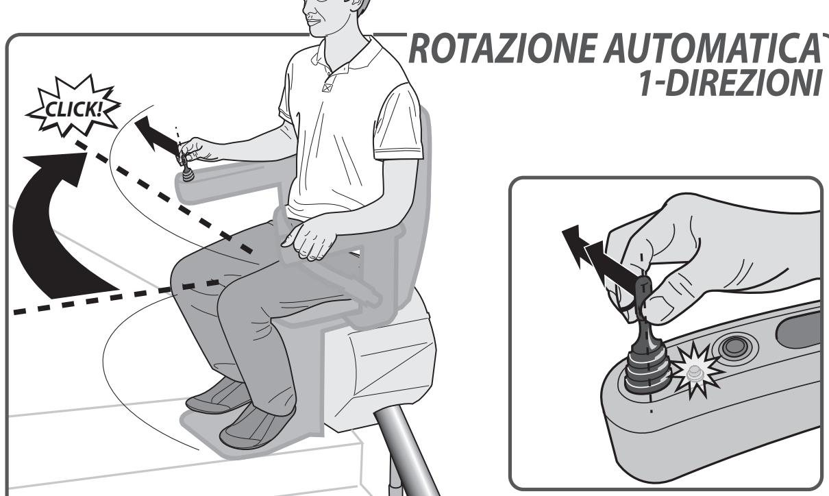
Con il SEDILE GIREVOLE AUTOMATICO opzionale, è possibile ruotare automaticamente il sedile alla fine della guida nella direzione di marcia. Per farlo, è necessario mantenere il joystick puntato verso l'alto.
