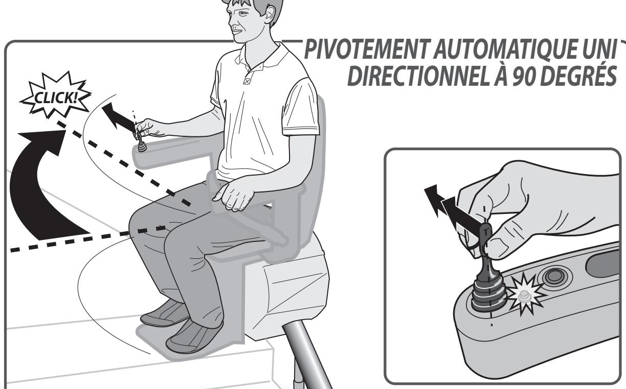
Avec l'option de SIÈGE PIVOTANT AUTOMATIQUE, vous pouvez laisser le siège pivoter automatiquement à l'extrémité du rail. Pour ce faire, maintenez la manette orientée dans le sens de la montée.
