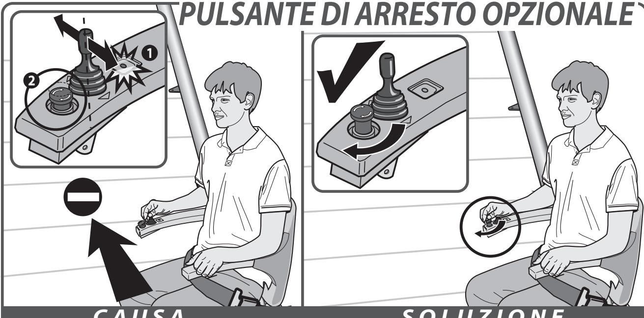
**Problema:** il montascale non si muove in nessuna direzione e il LED[1] lampeggia quando il joystick emette un comando e il pulsante di arresto è illuminato[2].
