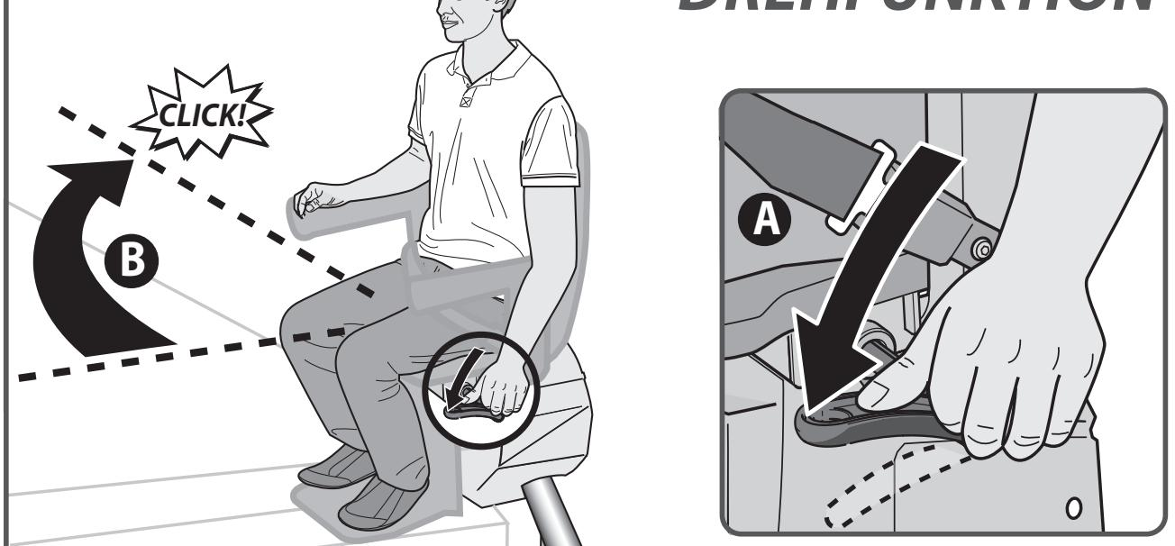
Der Lift stoppt automatisch am Schienenende. Sie können den Sitz nun von Hand drehen, damit Sie bequemer aufstehen und wieder Platz nehmen können. Drücken Sie dazu den Hebel nach unten {A}. Drehen Sie den Sitz, bis Sie ein Klickgeräusch hören. Der Sitz befindet sich jetzt in der richtigen Position {B}.
