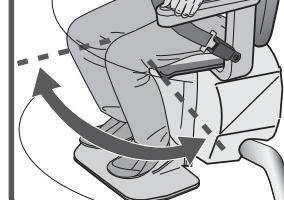
L'illustration ci-contre montre les éléments à l'aide desquels vous pouvez commander le siège Classic. Afin d'améliorer le confort d'assise et la facilité d'utilisation, vous pouvez équiper le siège Classic des options suivantes : Pivotement automatique uni directionnel à 90 degrés, repose-pieds automatique, rail escamotable et pivotement automatique bi directionnel à 180 degrés.
